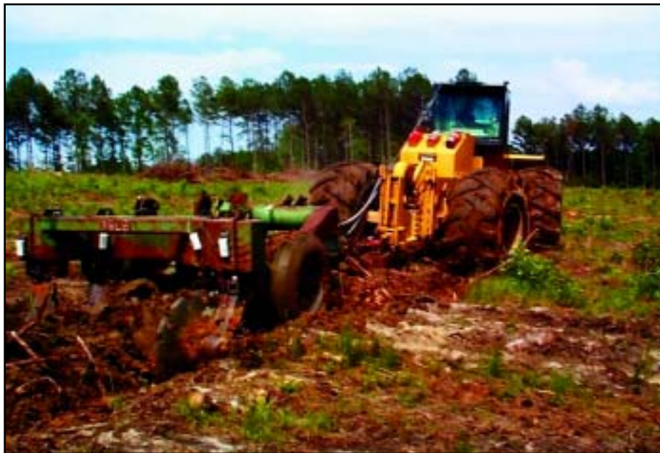
Mehanizovana priprema terena: sub-soiling obrada diskovima
